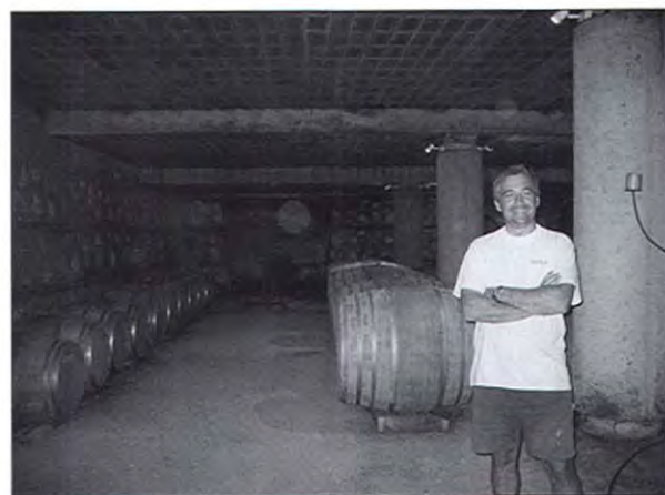
Le caveau d'élevage, adossé au talus, et recouvert par 2 m de terre, bénéficie d'une température favorable à l'élevage du vin qui se fait en fûts de chêne.
