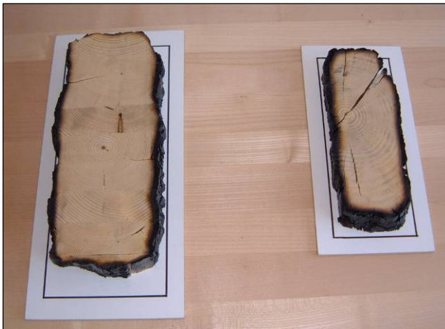
Figure 18 : Comportement du bois au feu (source Farmwood/CNDB)
